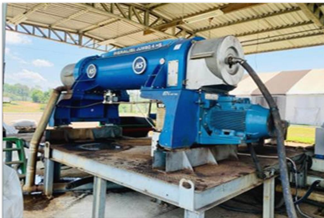
Figura 39 – Decanter centrífugo Jumbo e Big Bags para transporte da massa de lodo desidratado
