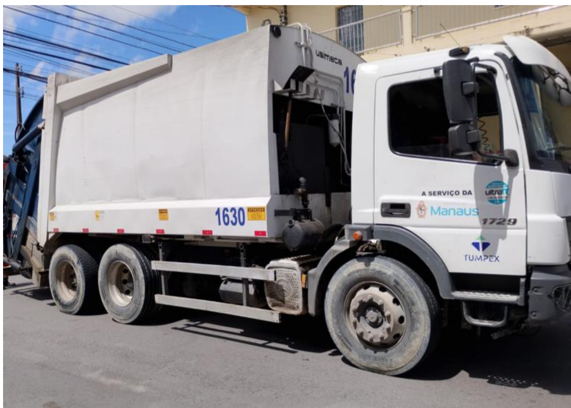
Figura 17 – Coletor compactador de 19 m 3 da Tumpex
