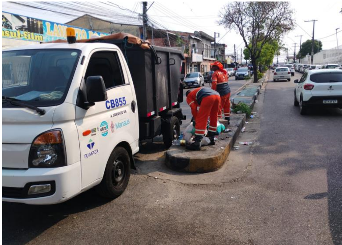
Figura 19 – Coletor compactador de 3,5 m 3 da Tumpex
