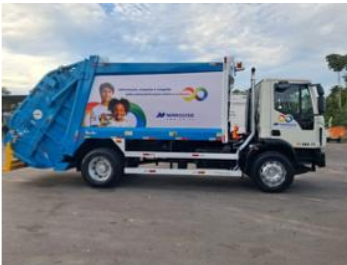
Figura 10 – Coletores compactadores de 15 m 3 da Marquise Ambiental
