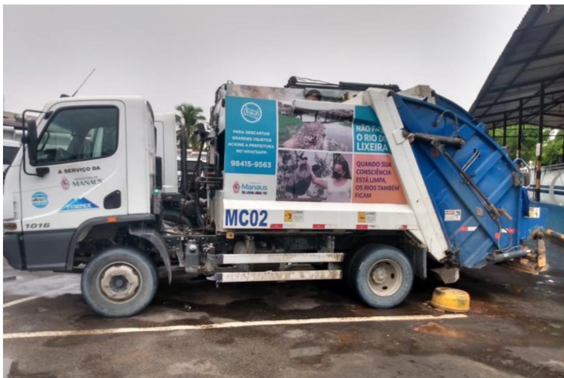
Figura 18 – Coletor compactador de 6 m 3 da Tumpex
