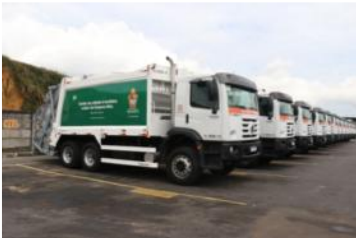
Figura 11 – Coletores compactadores de 19 m 3 da Marquise Ambiental
