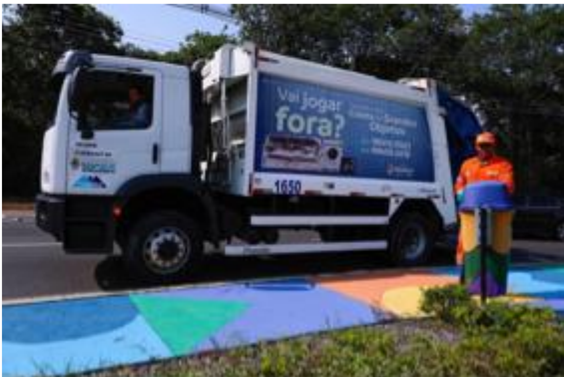
Figura 16 – Coletor compactador de 15 m 3 da Tumpex
