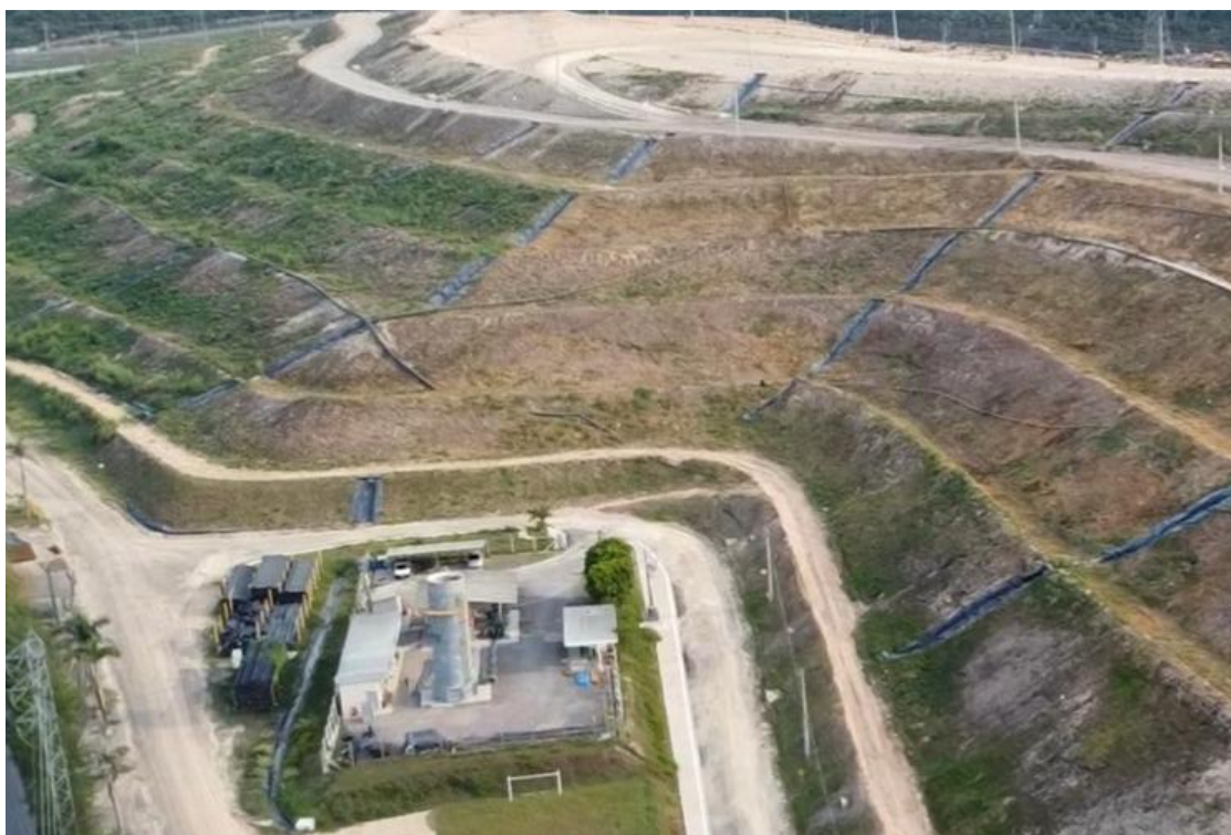
Figura 78 – Instalações de medição e queima dos gases do aterro
