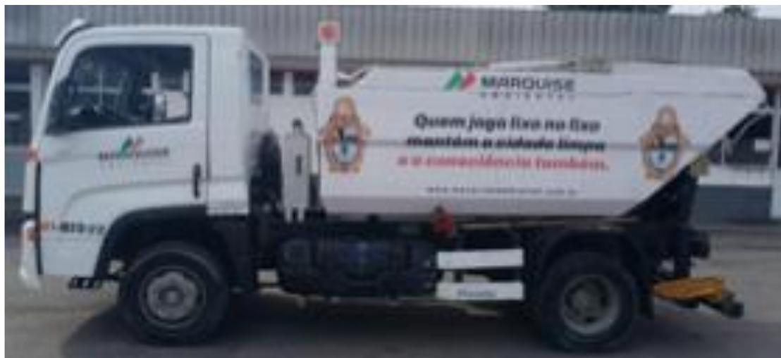
Figura 12 – Coletores basculantes de 5 m 3 da Marquise Ambiental
