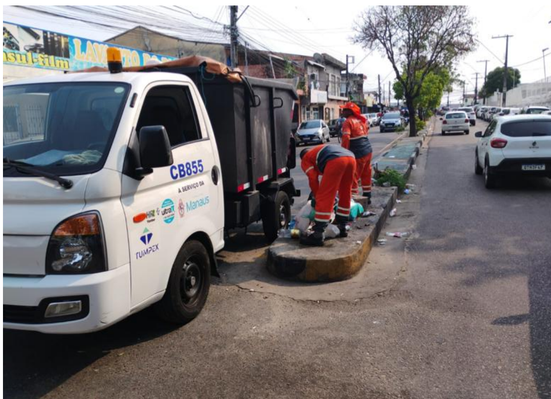
Figura 19 – Coletor compactador de 3,5 m 3 da Tumpex
