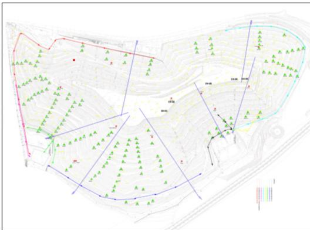
Figura 74 – Linhas de condução de lixiviado até as lagoas
