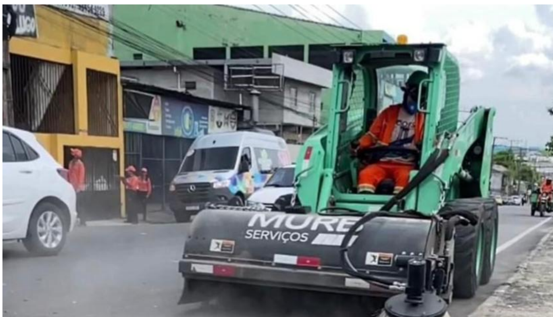
Figura 108 – Varrição mecanizada da empresa Murb
