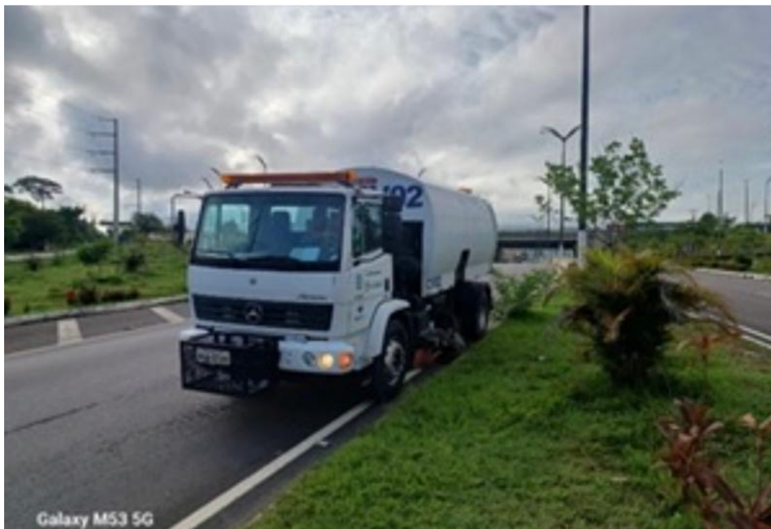
Figura 107 – Varrição mecanizada em avenidas, equipamento de 6 m 3 .
