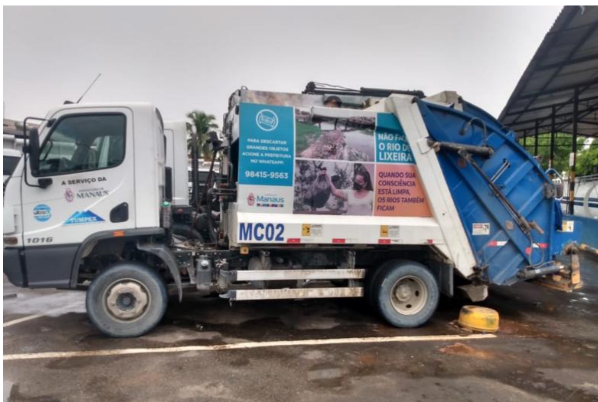
Figura 18 – Coletor compactador de 6 m 3 da Tumpex
