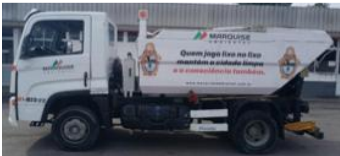
Figura 12 – Coletores basculantes de 5 m 3 da Marquise Ambiental
